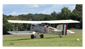
Son fuselage est fait de tubes d'aluminium, très léger comparé au bois des autres avions. Le biplan a deux ailes superposées en toile tendue. Elles sont cousues par des femmes car les hommes sont sur le champ de bataille. L'avion a un moteur Renault.
